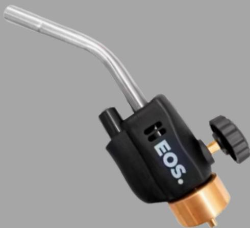
O Maçarico Manual Automático Portátil EOS Fire Plus é ideal para soldagem em tubos de cobre até 1 polegada. Feito com corpo em ABS reforçado, possui acionamento automático, chama rotativa e controle variável. Utiliza refis Mapp, alcança temperaturas de **até 2200° Celsius e oferece uma soldagem mais rápida e eficiente.**
