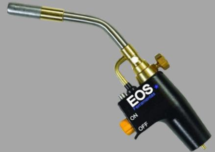
Os Maçaricos Profissionais EOS foram projetados para soldagem em tubos de cobre ou alumínio. **Com uma chama otimizada alcançando até 1800°C**, oferece a função trava chama. Desenvolvidos para cilindros de 395g a 495g na vertical, seguem o padrão GGAC600, permitindo rotação de 360°. Possuem bico em aço inox, ignição instantânea para acendimento automático e ajuste de chama. Ideal para soldas profissionais.
