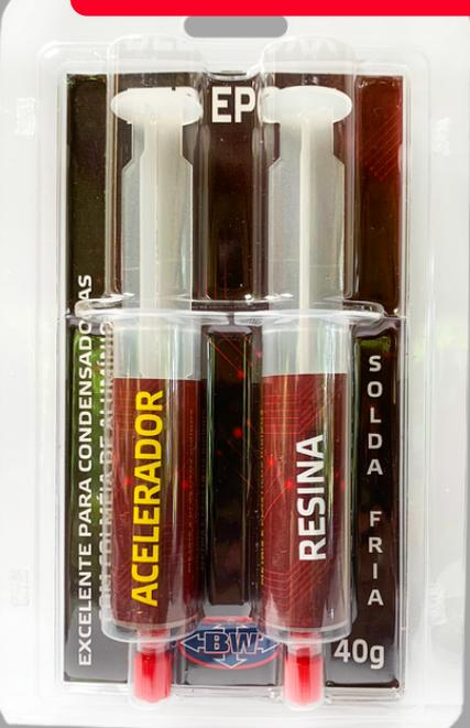
Solda fria es una solución simple, rápida y eficiente para agujeros y grietas en todos los metales y plásticos rígidos. Soporta presiones de hasta 3000 psi, temperaturas de hasta 180°C positivos y -35°C negativos. Su curado completo ocurre en hasta 48 horas. Puede ser utilizada en una variedad de aplicaciones, incluyendo evaporadores de aluminio, serpentines de calefacción, tanques de agua caliente, tuberías, válvulas, motores automotrices, radiadores, ollas, condensadores, entre otros.
